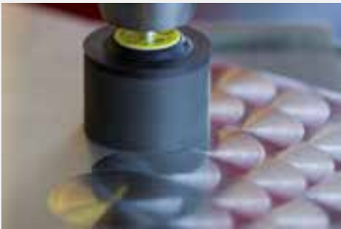
Exemple pour un meulage décoratif avec une meule à marbrer R-Flex SFM 656 sur de la tôle inox
